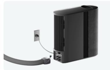
**14** Collega l'estremità del cavo al retro dell'Hub. Una volta fissato, dovresti sentire un clic. Collega l'USB collegato anche al retro dell'Hub.
